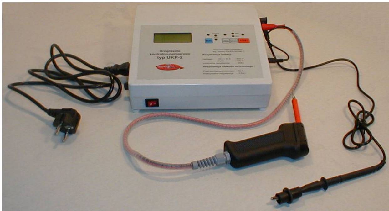
Fot. 7 - Zestaw UKP-2 służący do badania rezystancji izolacji z końcówką „pistoletową”.
