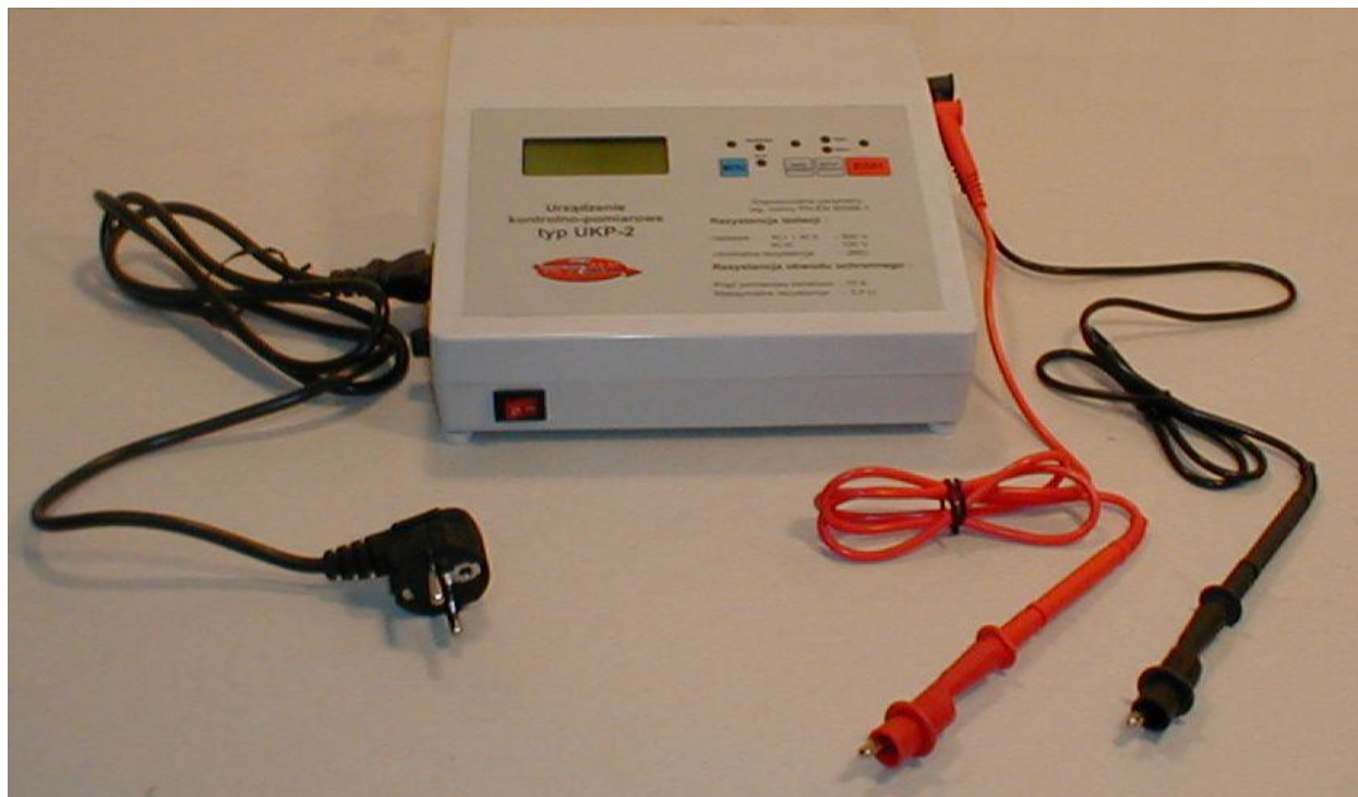
Fot. 6 - Zestaw UKP-2 służący do badania rezystancji izolacji z przewodami.
